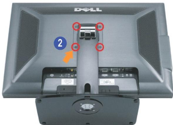
將托架放在平坦的表面上，然後依下列步驟裝上顯示器托架：
